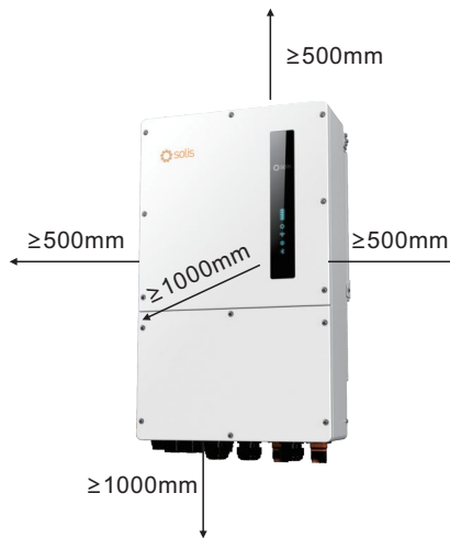
Kuva 3.5 Invertterin asennusetäisyys
